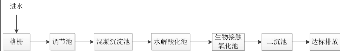
图 4-1 项目自建污水处理设施工艺流程图
