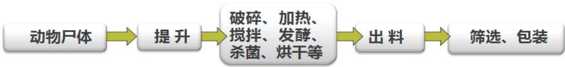
图 2.2-6 病死猪及猪胞衣无害化工艺流程图
